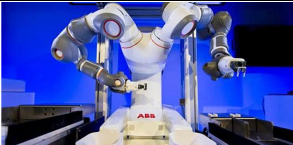
图表 28 ABB 首台人机协作柔性工业双臂机器人
